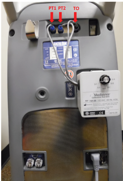
Рисунок 2.5. Модуль управления системой регулирования температуры Arctic Sun™ с подсоединенным ПКУ
