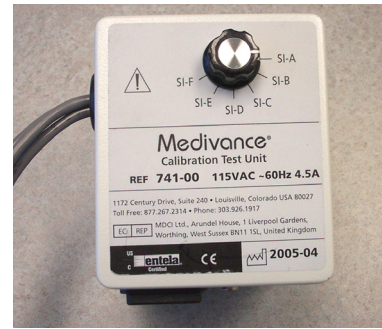
Figura 2.6. Interruptor 1 da UTC
