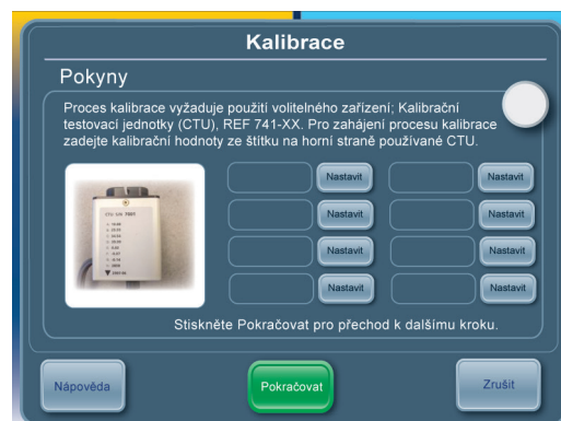
Obrázek 2.2. Obrazovka Kalibrace řídicího modulu systému ARCTIC SUN™ Temperature Management System
