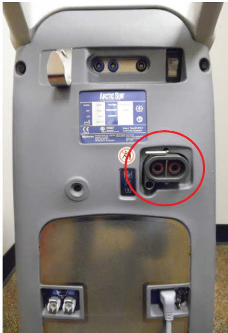
Figur 2.4. Kontrollmodul till ARCTIC SUN™ temperaturhanteringssystem med vätskeslangen borttagen
