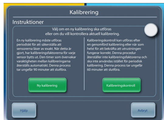
Figur 2.3. Kalibreringsskärmen för ARCTIC SUN™ temperaturhanteringssystemets kontrollmodul
