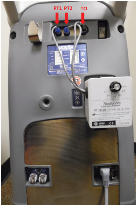
Figure 2.5. Module de commande du système de gestion de la température ARCTIC SUN™ avec CTU relié
