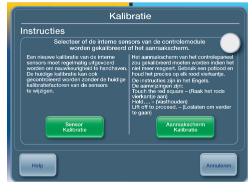
Afbeelding 2.1. Kalibratiescherm op de controlemodule van het ARCTIC SUN™ Temperatuurbeheersysteem
