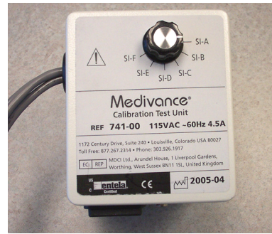
Figure 2.6. Interrupteur 1 du CTU
