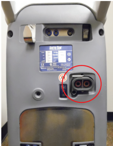
Рисунок 2.4. Модуль управления системой регулирования температуры Arctic Sun™ с отсоединенной системой доставки жидкости
