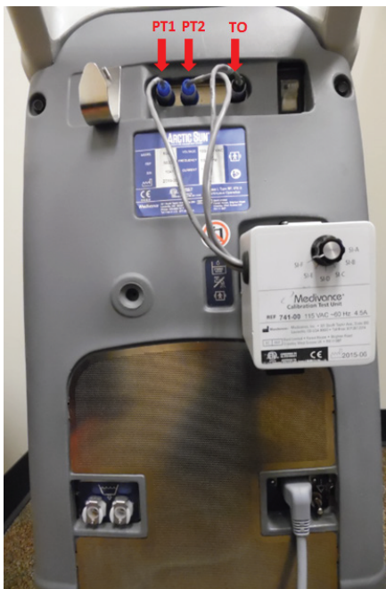
Figur 2.5. Kontrollmodul till ARCTIC SUN™ temperaturhanteringssystem med ansluten CTU
