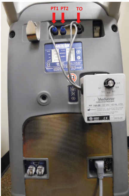
图 2.5. 连接上 CTU 的 ARCTIC SUN™ 体温控制仪控制模块
