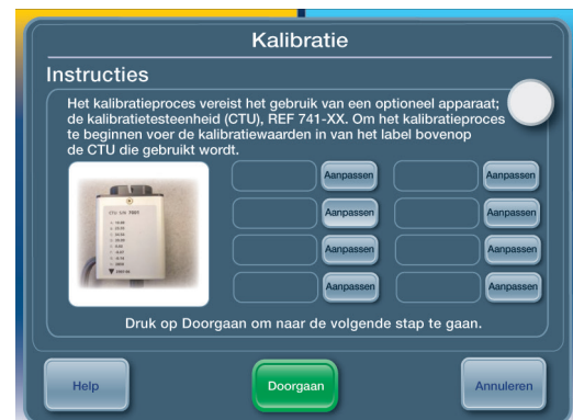
Afbeelding 2.2. Kalibratiescherm op de controlemodule van het ARCTIC SUN™ Temperatuurbeheersysteem
