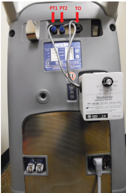
2.5. ábra ARCTIC SUN™ hőmérséklet-kezelő rendszer vezérlőegység csatlakoztatott CTU egységgel
