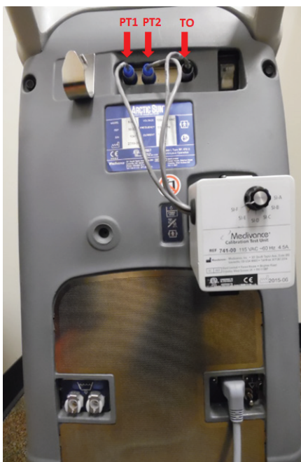
Fig. 2.5. Kontrolmodul til ARCTIC SUN™ temperaturkontrollsystem med monteret CTU
