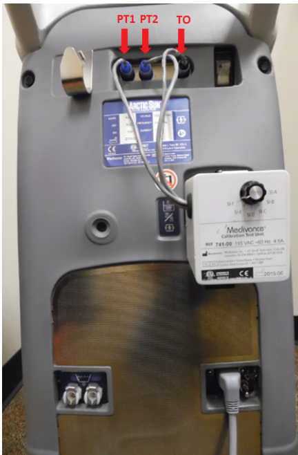
Figura 2.5. Modulo di controllo del sistema di gestione della temperatura Arctic Sun™ dopo il collegamento alla CTU
