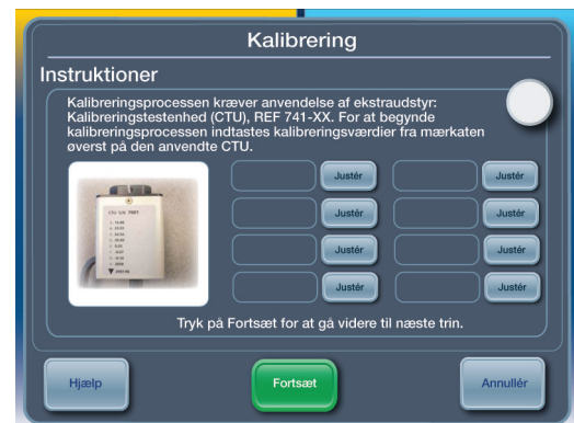
Fig. 2.2. Kalibreringsskærm på kontrolmodulet til ARCTIC SUN® temperaturkontrolsystem
