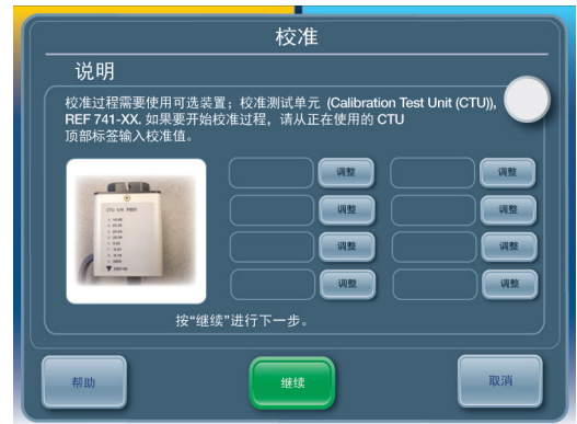
图 2.2. ARCTIC SUN® 体温控制仪控制模块校准屏幕
