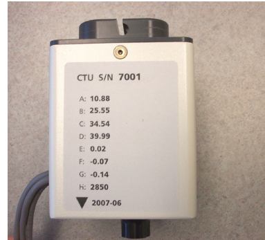
Figure 2.8. Données d'étalonnage du CTU
