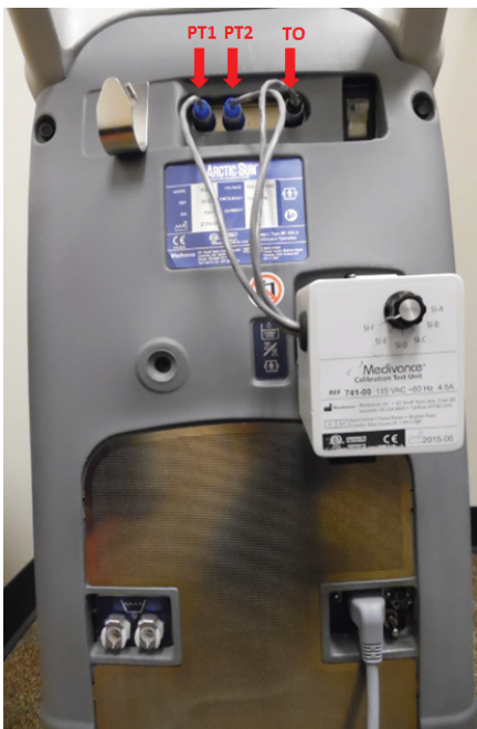
2.5. ábra ARCTIC SUN ® hőmérséklet-kezelő rendszer vezérlőegység csatlakoztatott CTU egységgel
