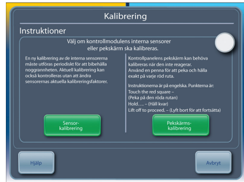
Figur 2.1. Kalibreringsskärmen för ARCTIC SUN® temperaturhanteringsystems kontrollmodul
