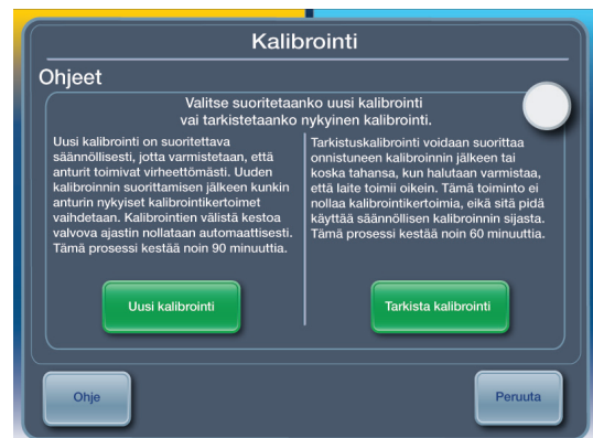
Kuva 2.3. ARCTIC SUN® -lämpötilanhallintajärjestelmän kontrollointimoduulin kalibrointinäyttö
