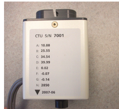
Figura 2.8. Dati di calibrazione dell'UTC
