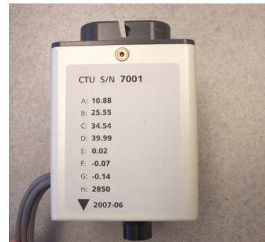
Figura 2.8. Datos de calibración de la UPC
