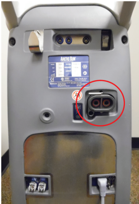
図 2.4. ARCTIC SUN® 温度管理システムのコントロールモジュールの液体供給ラインを外した図
