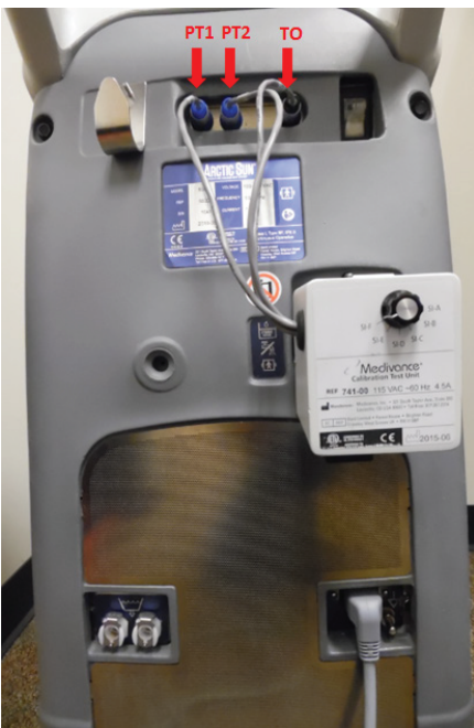
Figura 2.5. Modulul de comandă al sistemului de termoreglare ARCTIC SUN® cu CTU atașată
