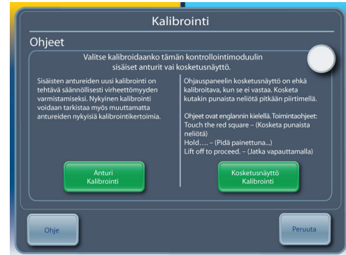
Kuva 2.1. ARCTIC SUN® -lämpötilanhallintajärjestelmän kontrollointimoduulin kalibrointinäyttö
