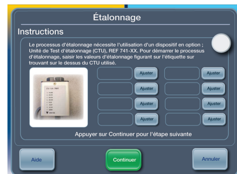
Figure 2.2. Écran d'étalonnage du module de commande du système de gestion de la température ARCTIC SUN®
