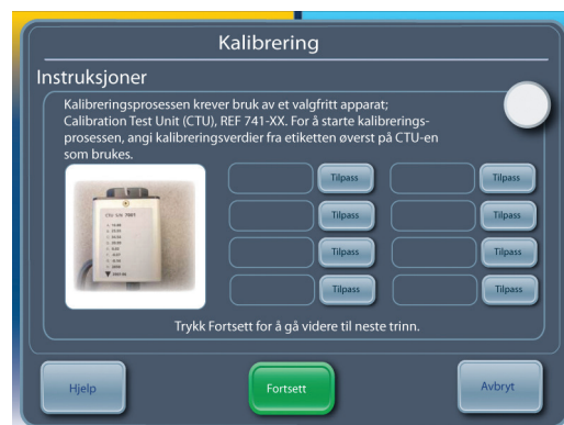
Figur 2.2. Kalibreringsskjermbildet for kontrollmodulen for ARCTIC SUN®-temperaturhåndteringssystemet
