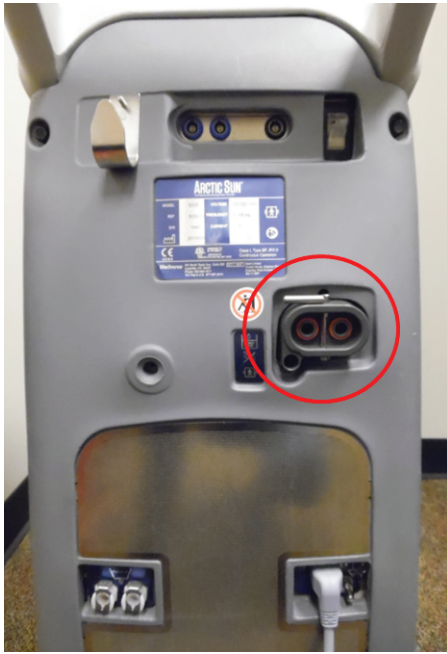
Figure 2.4. Module de commande du système de gestion de la température ARCTIC SUN® avec ligne d'administration de fluide retirée
