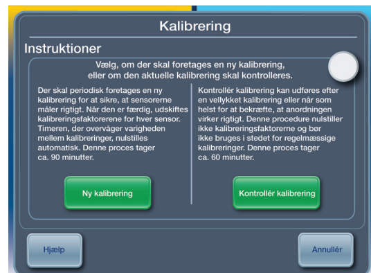
Fig. 2.3. Kalibreringsskærm på kontrolmodulet til ARCTIC SUN® temperaturkontrolsystem
