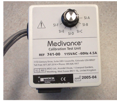
Figure 2.6. Interrupteur 1 du CTU
