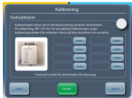
Figur 2.2. Kalibreringsskärmen för ARCTIC SUN® temperaturhanteringsystems kontrollmodul
