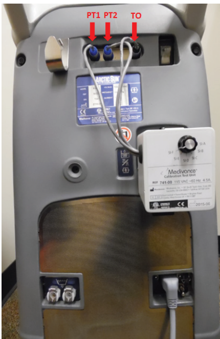
Obrázok 2.5. Kontrolný modul systému regulácie teploty Arctic Sun® s pripojenou jednotkou CTU
