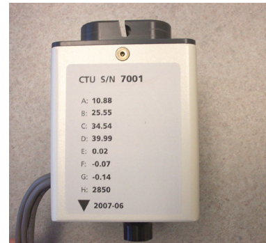
Abbildung 2.8. Kalibrierdaten auf dem Kalibrierungsprüfgerät
