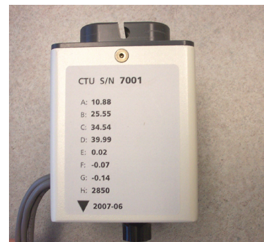
Obrázok 2.8. Kalibračné údaje jednotky CTU
