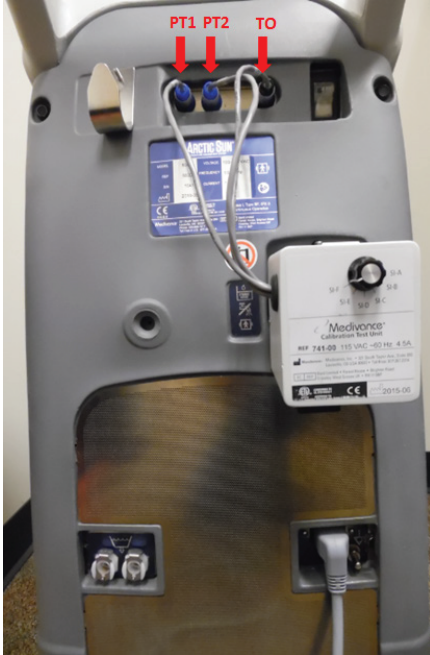
Şekil 2.5. CTU takılı halde ARCTIC SUN® Sıcaklık Yönetim Sistemi Kontrol Modülü
