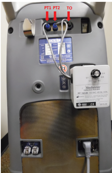
Figur 2.5. Kontrollmodul i ARCTIC SUN ® -temperaturhåndteringssystemet med CTU tilkoblet
