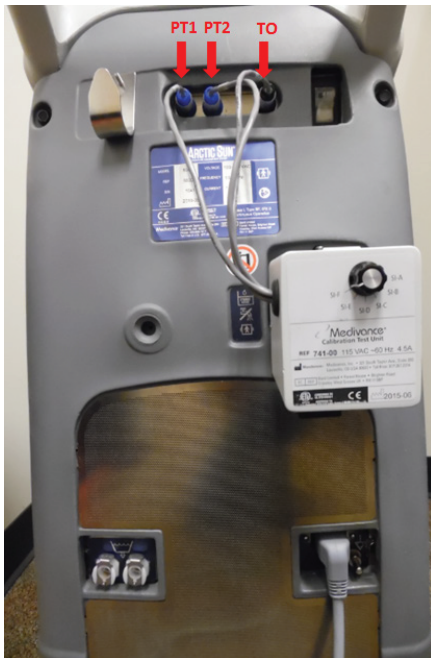
Figura 2.5. Módulo de control del sistema de gestión de temperatura ARCTIC SUN® con la UPC conectada
