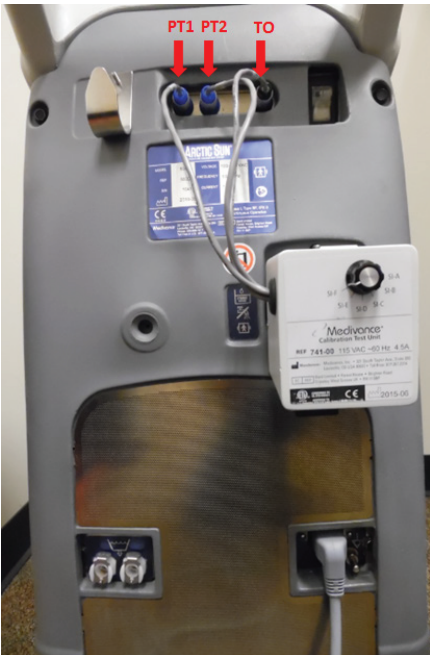
그림 2.5. CTU가 부착된 Arctic Sun ® 온도 관리 시스템 컨트롤 모듈
