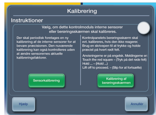
Fig. 2.1. Kalibreringsskærm på kontrolmodulet til ARCTIC SUN® temperaturkontrolsystem
