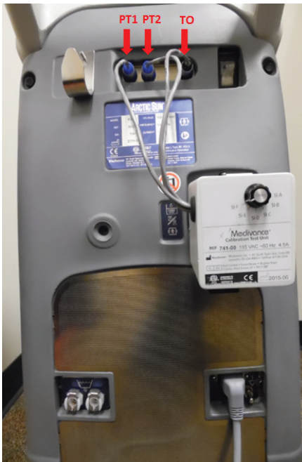
図 2.5. ARCTIC SUN® 温度管理システムのコントロールモジュールにCTUを取り付けた図
