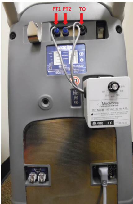
图 2.5. 连接上 CTU 的 ARCTIC SUN ® 体温控制仪控制模块
